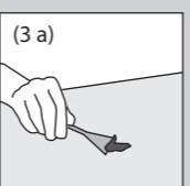
**(3 a+b) Madpletter, tyggegummi, neglekak, indtørret maling eller lignende** kan typisk fjernes, ved brug af en plastik- eller træskraber eller en metal klinge, som den der anvendes til rengøring af keramiske glas kogeplader. Hvis der efterlades metal rester på overfladen, kan man bruge et flydende skuremiddel, samt vand og den bløde side af en Scotch-Brite® svamp.
