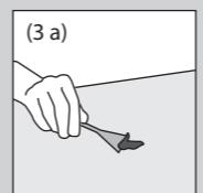
(3 a+b) Per rimuovere in **maniera ottimale i residui di materiale essiccati sulle superfici, come ad esempio gomma da masticare, smalto per unghie o vernice**, utilizzare inizialmente un raschietto di plastica o legno oppure una lametta. Per mezzo di questi strumenti si possono anche pulire i piani di cottura in vetroceramica. Per rimuovere i residui metallici depositati in superficie si può impiegare il latte detergente Mittels Viss® con acqua e la parte morbida della spugna Scotch-Brite®.
