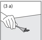
**(3 a+b)** För att **avlägsna intorkade livsmedel** som t.ex. tuggummi eller intorkad nagellack, färg mm används bäst i en plast- eller tråskrapa utan metallkant. I fall rester kvarstår kan Vim®-skurmjölk inkl. Vatten och på den mjuka sidan av en Scotch-Brite®-svamp användas.
